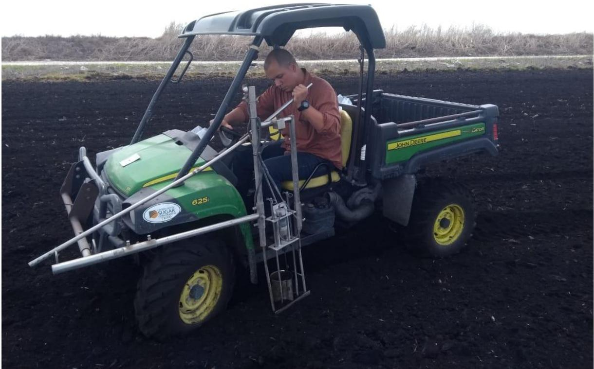
**Figura 1.** Exemplo do veículo multiuso Gator™ XUV Crossover da John Deere, equipado com trado de rosca.
