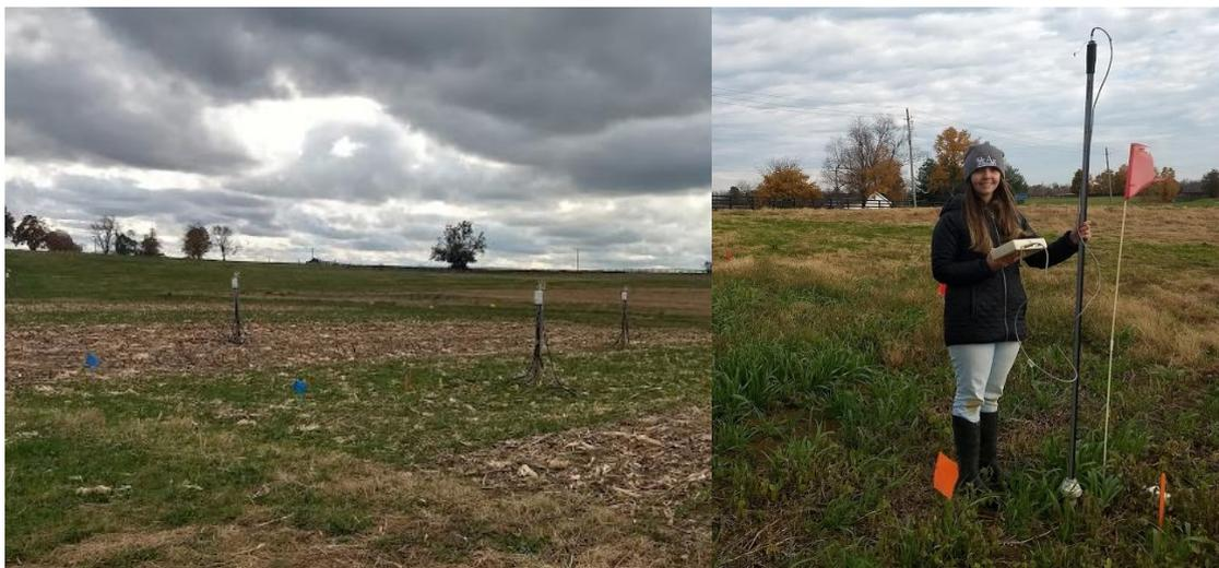
**Figura 19.** Tecnologias para avaliação de umidade, temperatura e condutividade elétrica do solo.
